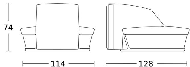
Possibile altezza di montaggio: 2,00 m – 5,00 m
